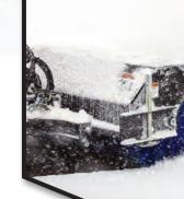
FLOATING TORSION SUSPENSION SYSTEM ALLOWS THE BROOM TO FLOAT WHILE SWEEPING UNEVEN AREAS
